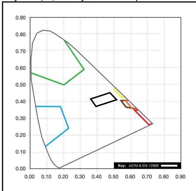
Защитные пленки серии OL-2000 соответствуют действующим в настоящий момент требованиям к цветам, используемым в дневное и ночное время, для ASTM D4956 и EN-12889.
