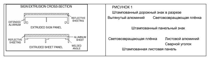
Как правило, заказчики приобретают алюминиевые заготовки у опытного поставщика, который обрабатывает их по следующей спецификации: обезжиренный, вытравленный, покрытый хромированной обработкой. Настоятельно рекомендуется использование материалов с качественной обработкой от опытного, надежного поставщика.
