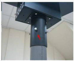
Скрепите основу с трубой с помощью шестиугольных винтов M6
