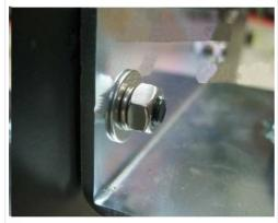
Закрепите кронштейн на знаке при помощи гайки, шайбы и шестиугольного винта
