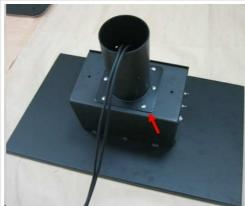
Используйте винты M4 для скрепления основы и солнечной панели с батарейным блоком
